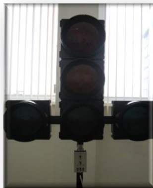
Действующий светофор с дополнительными секциями
